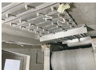
▲磁力で不燃ごみ・粗大ごみの中から鉄類を選別する磁選機
